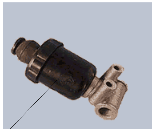
Рисунок 2.33 - Противозамерзатель 1- кнопка толкателя
