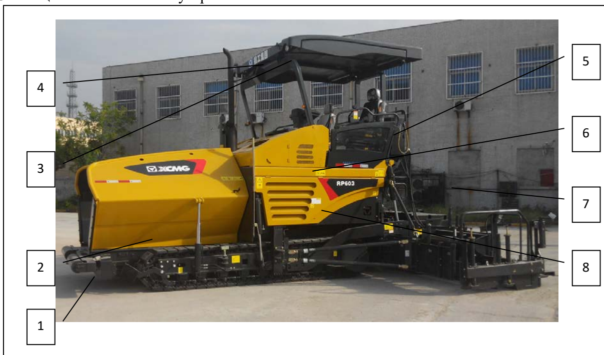
Рис. 3-1 Защитные элементы и устройства безопасности
