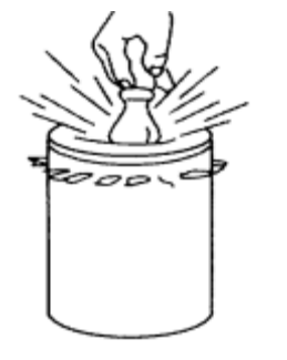
Рис. 3-16 Очистка наружного элемента фильтра
