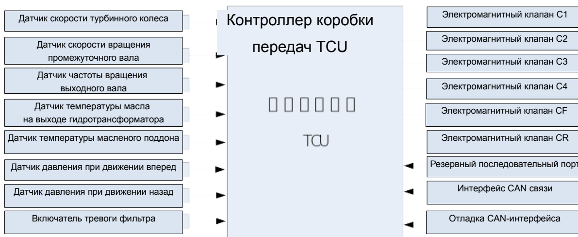
Рисунок 2-1 Принципиальная схема электронной системы управления
