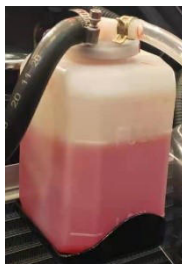
бак воды охлаждения
