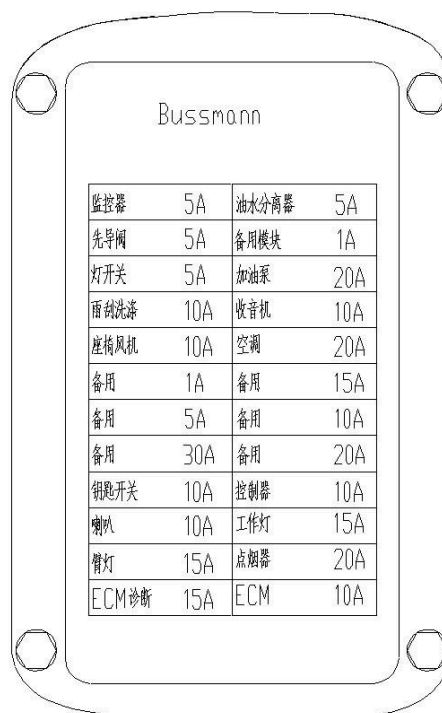
Задняя крышка блока предохранителей
