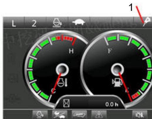
1 - Индикаторная лампа режима гидромолота
