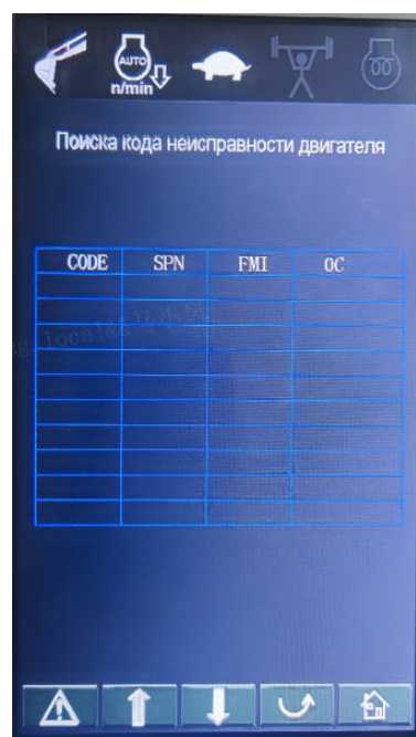
Интерфейс запроса о ошибке двигателя
