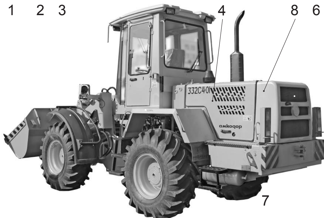
1, 3 - крылья; 2 - лестница; 4 - боковая дверца; 6 - задняя решётка; 7 - подножка; 8 - маска Рисунок 2.33 — Облицовка
