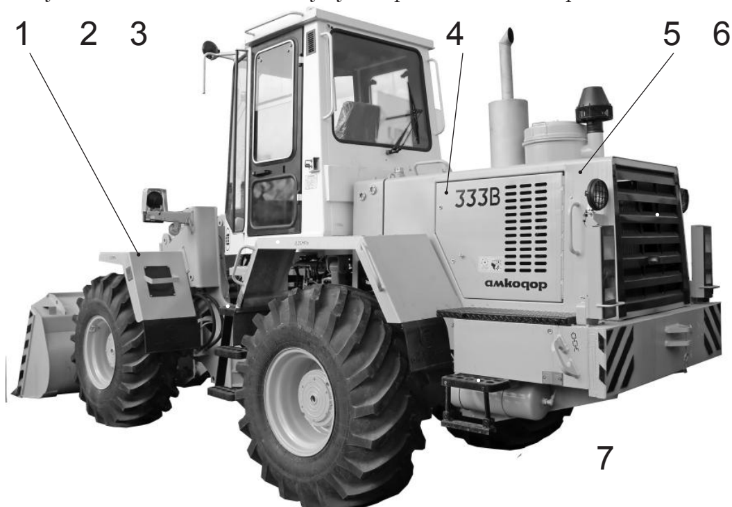
1, 3 - крылья; 2 - лестница; 4 - боковая дверца; 5 - каркас; 6 - задняя решётка; 7 - подножка Рисунок 2.32 — Облицовка
