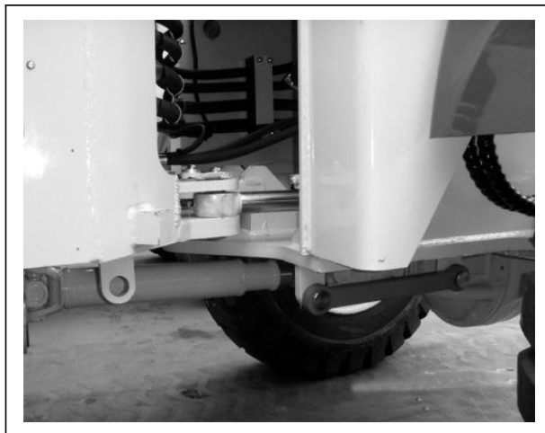
Рис.3-3 Фото арретированного штока поворота погрузчика
