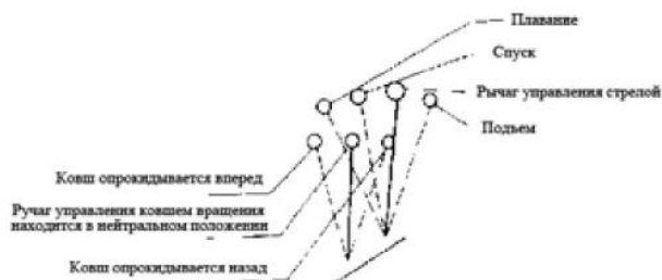
Рис.1-14 Схема разных положений рычагов управления
