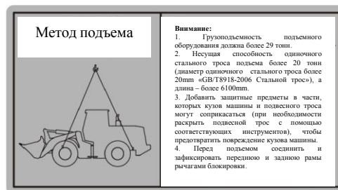
Рисунок 2-40 Схема подъема всей машины
