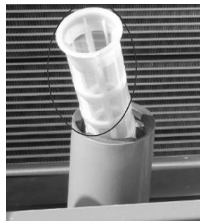
Рис 3-5 Фильтровальная сетка топливного бака
