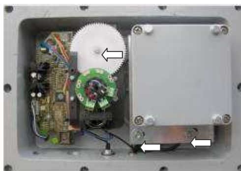
Рисунок 8.2 Регулировка датчика угла (стрелка указывает положение болтов)
