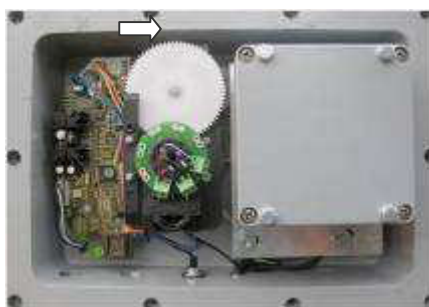
Рисунок 8.1 Регулировка датчика длины (направление вращения показано стрелкой)
