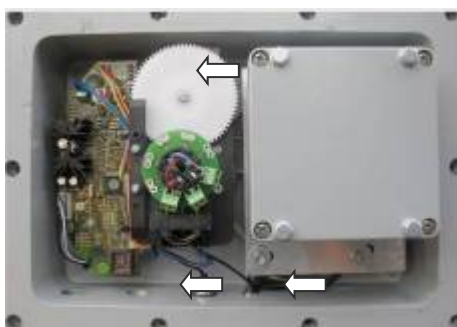
Регулировка датчика угла (по направлению стрелки).
