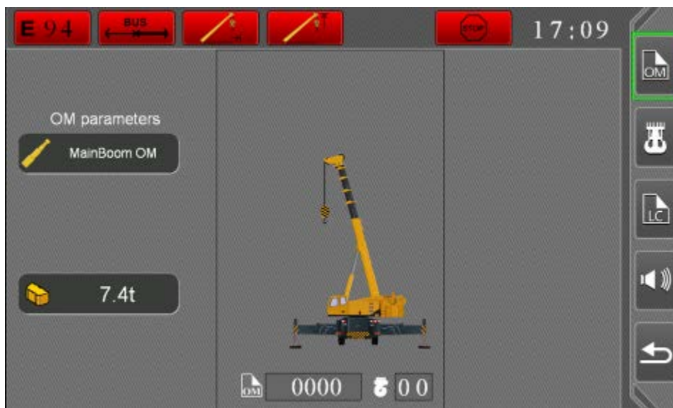
Дисплей настроек режима работы крана и кратности запасовки каната
