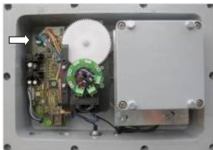
Регулировка датчика длины (по направлению стрелки).
