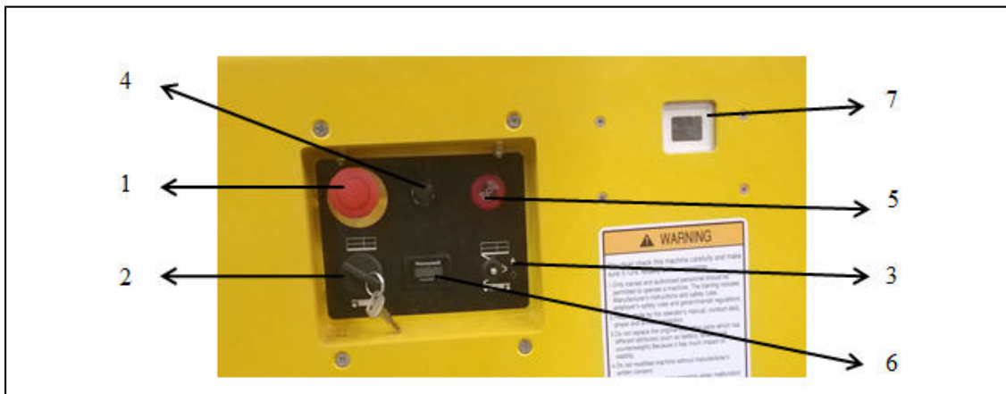
Рисунок 3-2 Наземный пульт управления(первое поколение)
