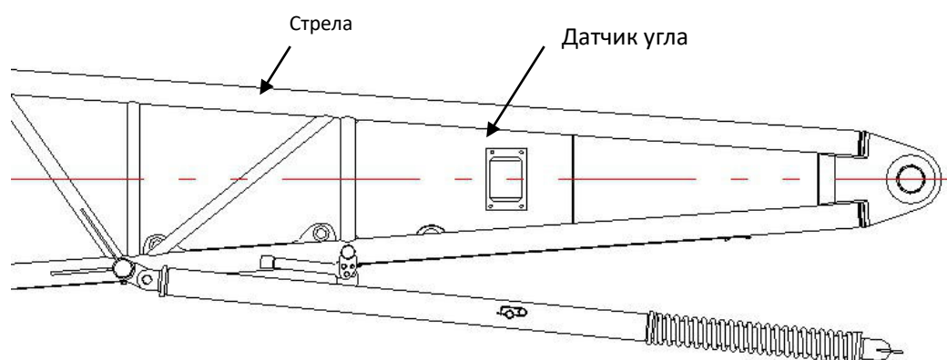
Рисунок 4-13 WC103 Установка датчика угла
