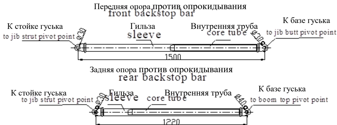
Рисунок 5-10 Устройство против опрокидывания фиксированного гуська
