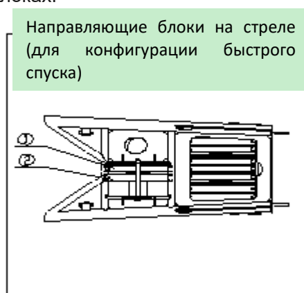
Рисунок 4-38 Направляющие блоки стрелы
