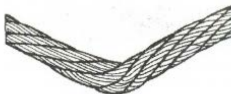
Рисунок 7-13 Нормы браковки канатов
