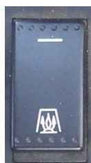
Рисунок 6-4 Выключатель холодного старта
