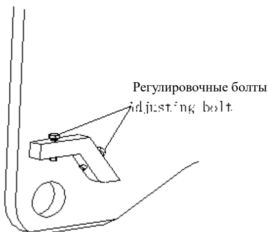
Рисунок 3-8 регулировка точности фиксации лебедки
