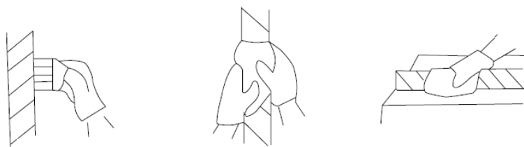
Рис. 14-06 Способы нанесения смазки на канат
