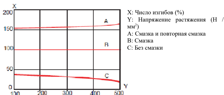
Рис. 14-05 Влияние на срок службы каната при разных условиях смазки
