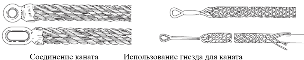
Рис. 14-10 Схема соединения каната
