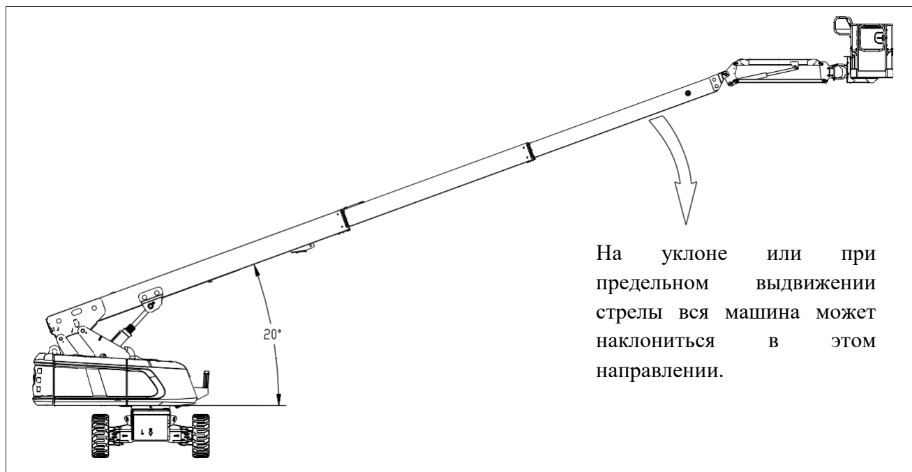
Рисунок 4-2. Положение минимальной передней стабильности
