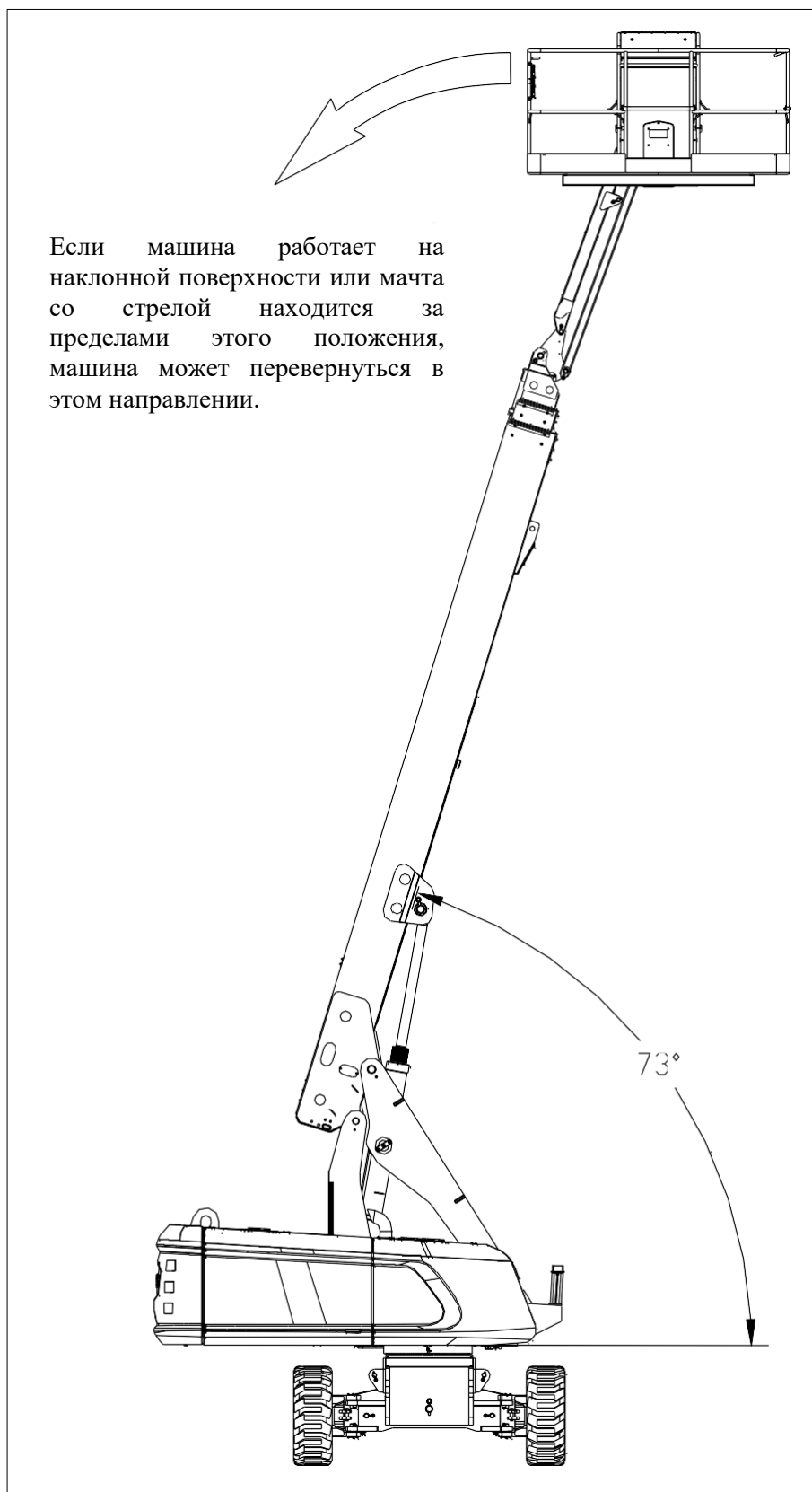
Рисунок 4-1. Положение минимальной задней стабильности
