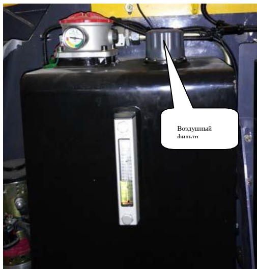
Рисунок 3-8. Воздушный фильтр гидравлического масляного бака
