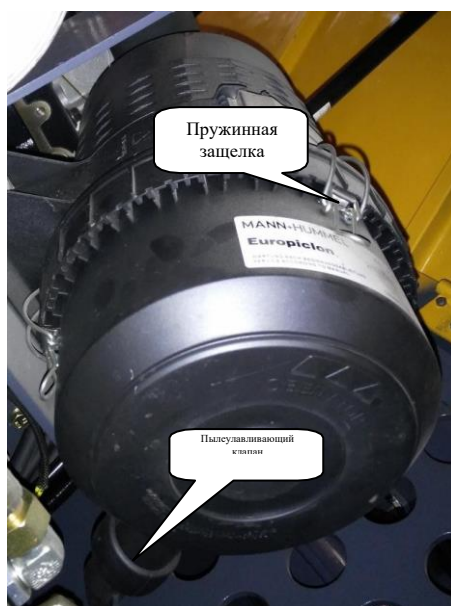
Рисунок 4-9. Замена главного элемента воздушного фильтра
