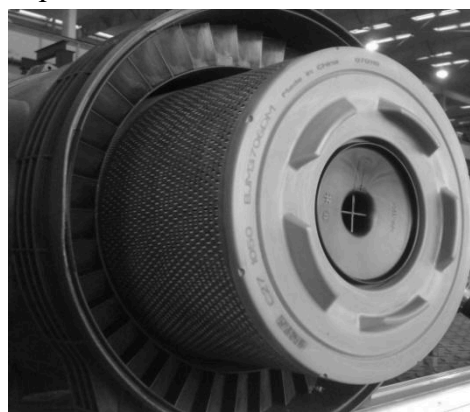
Демонтаж заднего корпуса воздушного фильтра
