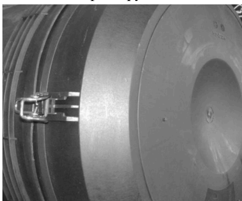
Разлом застёжки на корпусе хвостовой части воздушного фильтра
