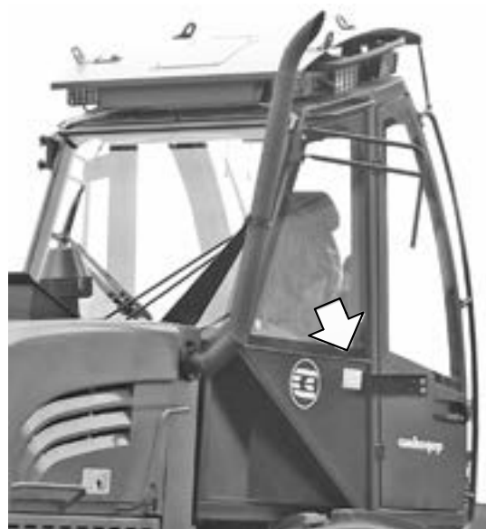
Рисунок 2.3 — Месторасположение маркировочной таблички
