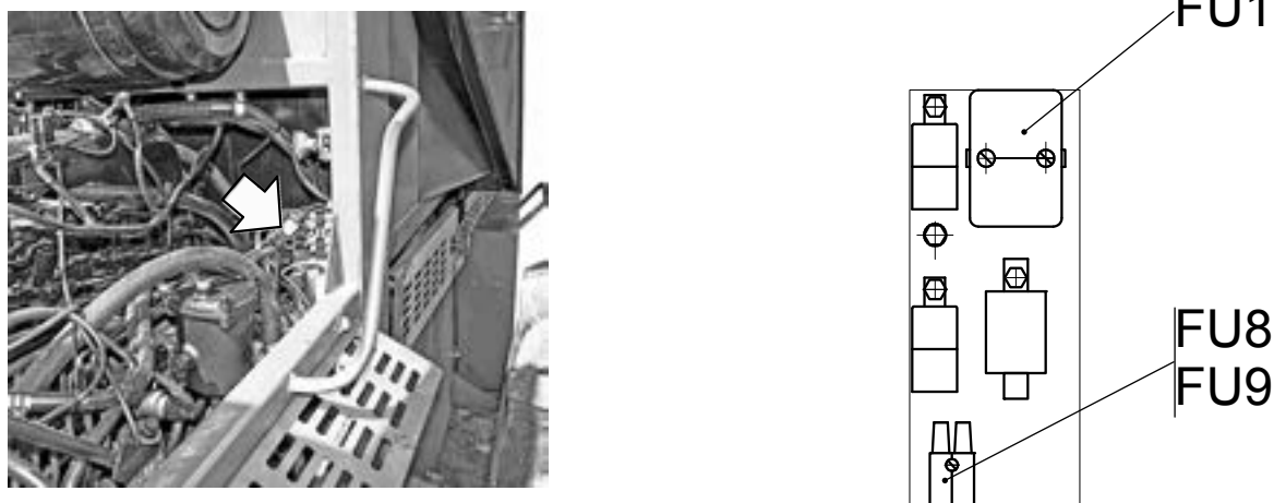
Рисунок 3.65 — Месторасположение блоков предохранителей
