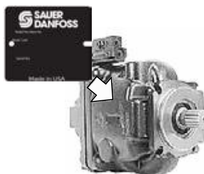
Рисунок 2.11 — Расположение маркировочной таблички насоса рабочего оборудования
