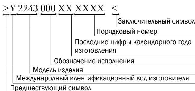
Расшифровка идентификационного номера тягача трелевочного АМКОДОР 2243
