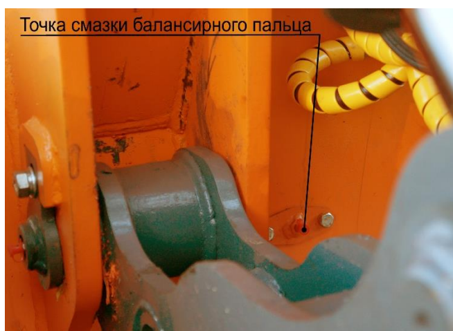
Рис.1.2.2. Гусеничное оборудование (гусеницы и левая балка условно не показаны)
