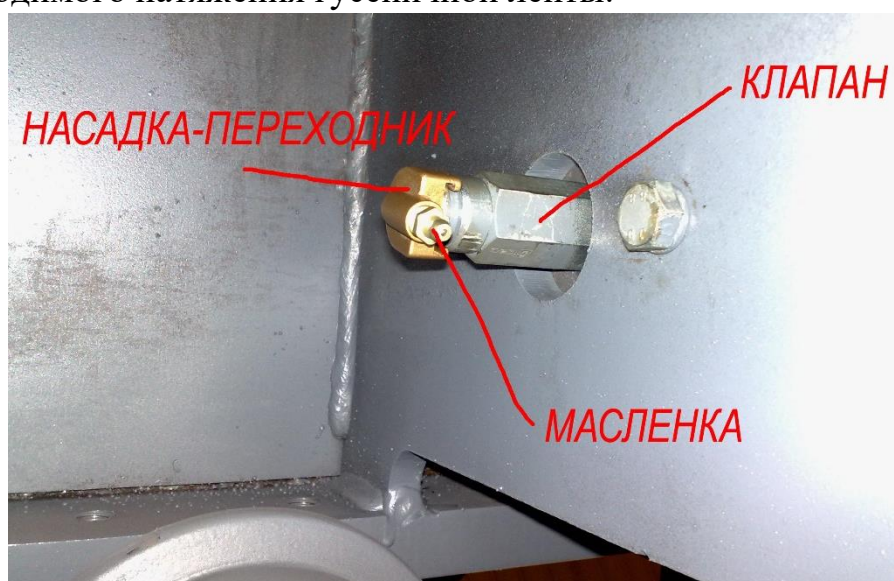
Рис.3.2.3.2 Место нагнетания густой смазки гидроцилиндра натяжения гусеничной ленты
