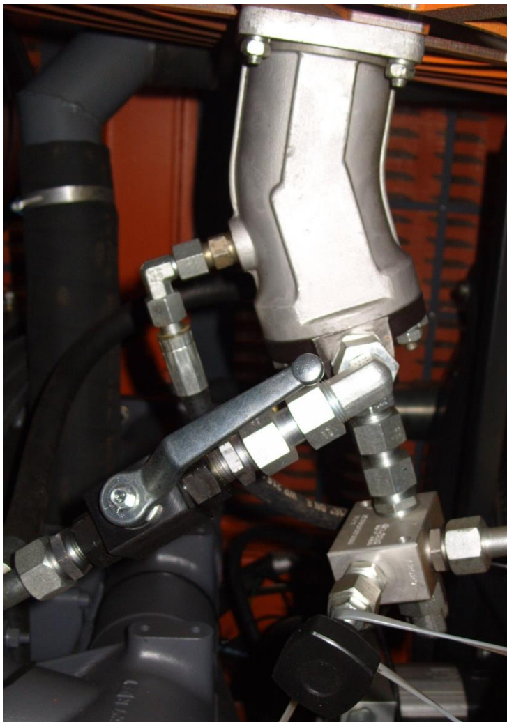
Рисунок 1.2.3.3 – Кран отключения вентилятора дополнительного калорифера.
