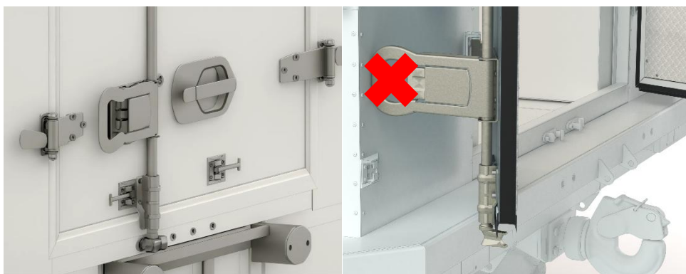
Рисунок 10 - Отпирание и запирание задней двойной двери.
