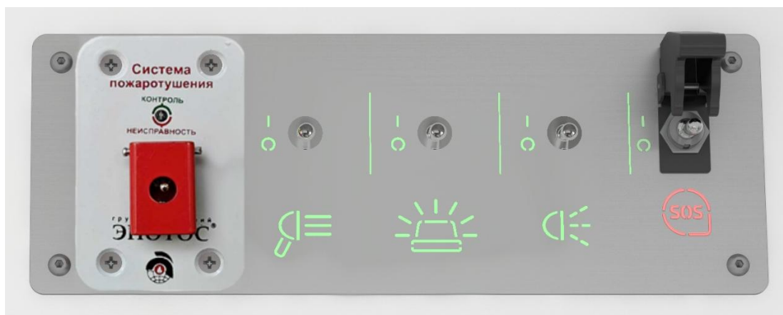
Рисунок 58 - Устройство пуска системы пожаротушения.
