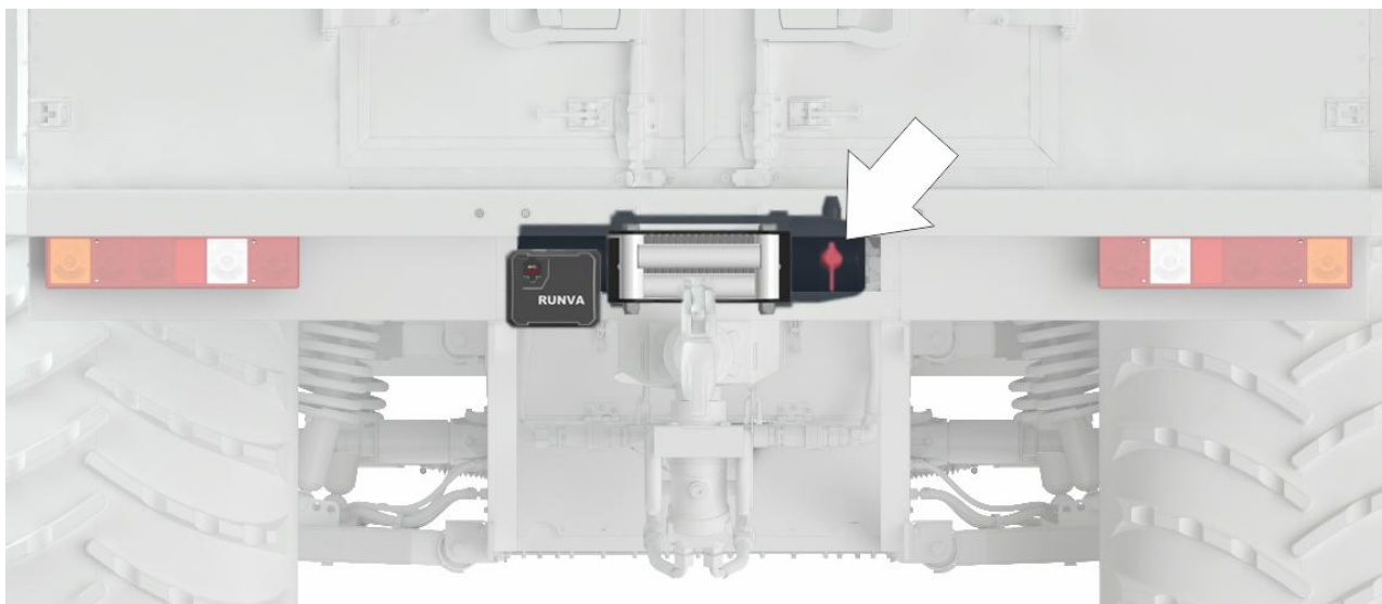
Рисунок 92 – Лебедка, рычаг свободного хода.
