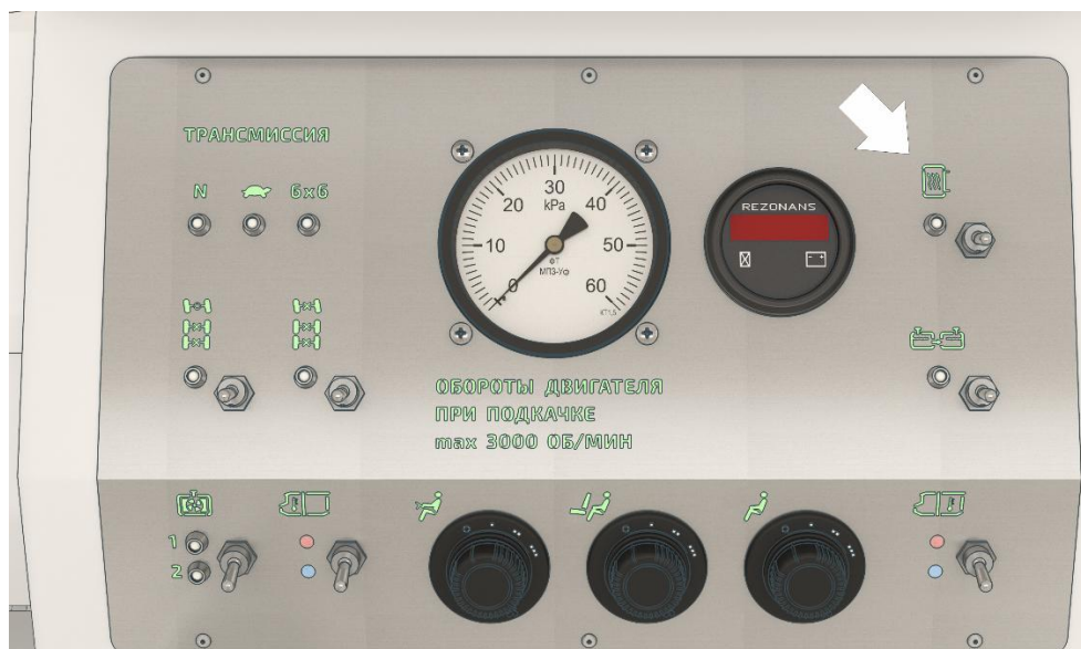
Рисунок 23 – Блок выключателей на панели приборов.
