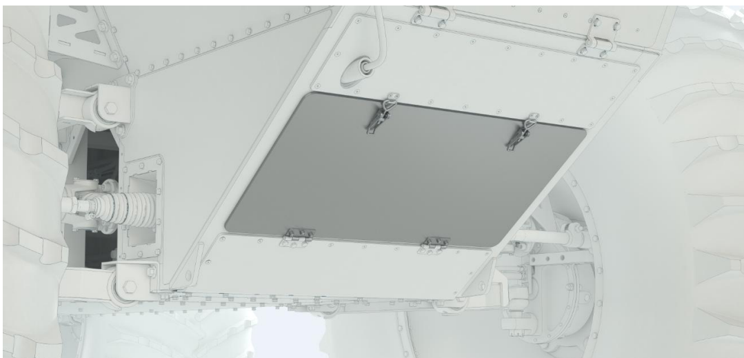
Рисунок 68 - Передний люк трансмиссионного отсека.
