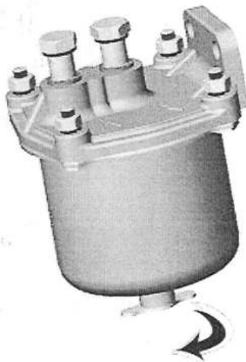
Рисунок 7.2 - Слив отстоя из фильтра грубой очистки топлива двигателя.
