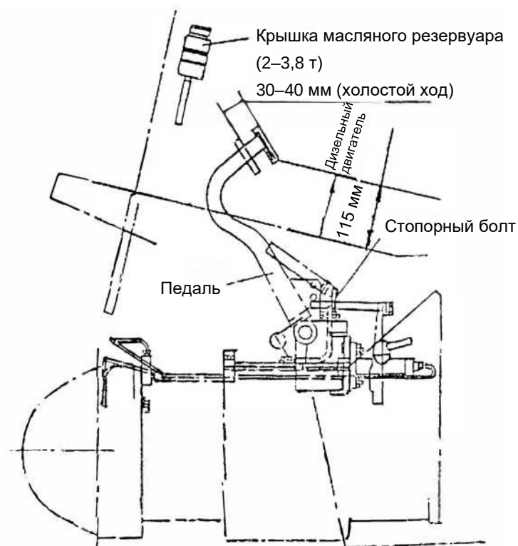
Рис. 8-7. Регулировка педали тормоза (механического вилочного погрузчика)
