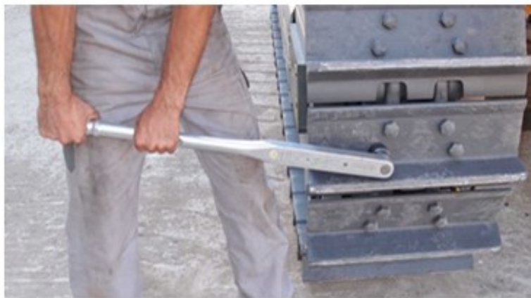
Рисунок 5.94. Проверка затяжки крепежа башмаков звеньев гусеницы
