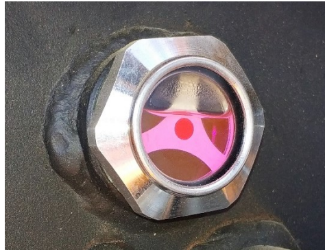
Рисунок 5.68. Смотровое окно расширительного бачка (проверка уровня охлаждающей жидкости в системе охлаждения)
