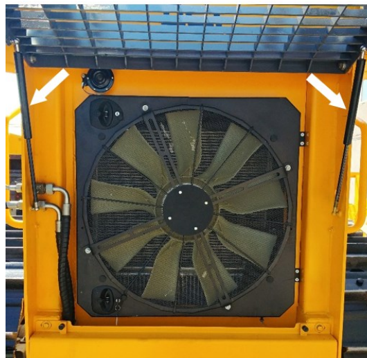
Рисунок 5.47. Место расположение газовых упоров
