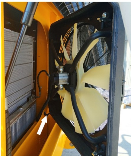
Рисунок 5.54. Рама вентилятора открыта, упор установлен
