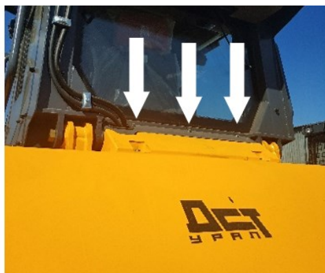
Рисунок 5.66. Размещение крепежных винтов декоративной планки
