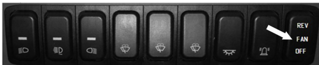
Рисунок 5.52. Щиток переключателей правый верхний (стрелкой показана трехпозиционная клавиша Fan Drive)
