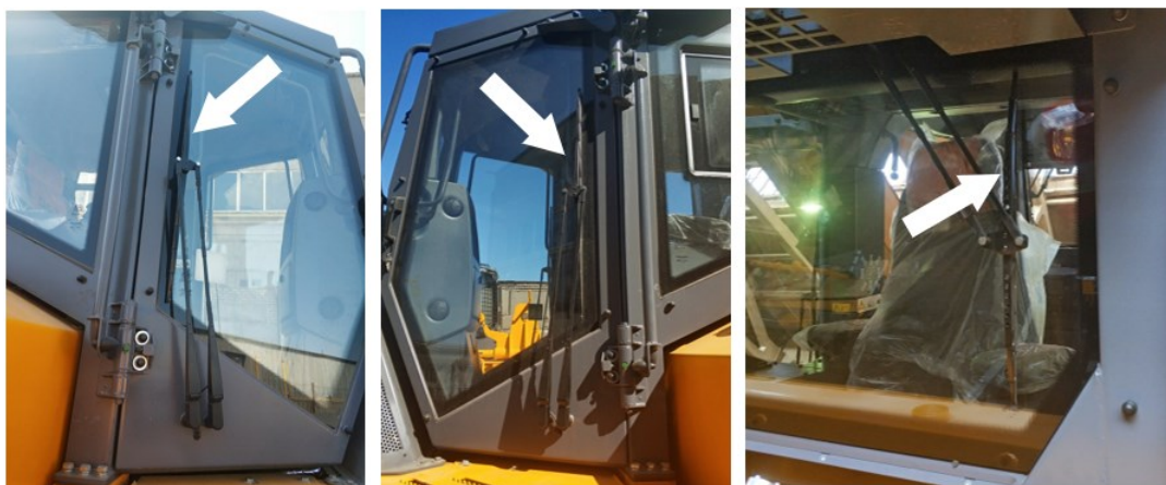
Рисунок 3.27. Размещение щеток стеклоочистителя на окнах кабины
