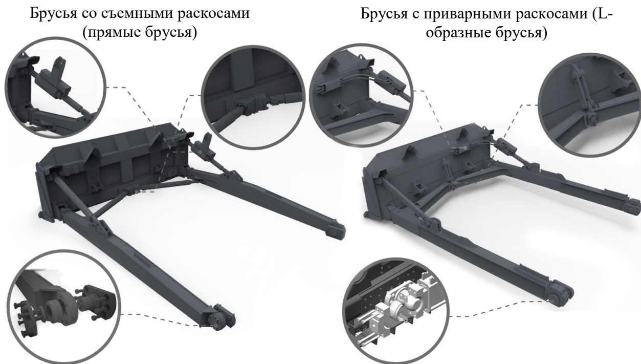
Рисунок 3.84. Отличия отвалов со съемными и приварными раскосами
