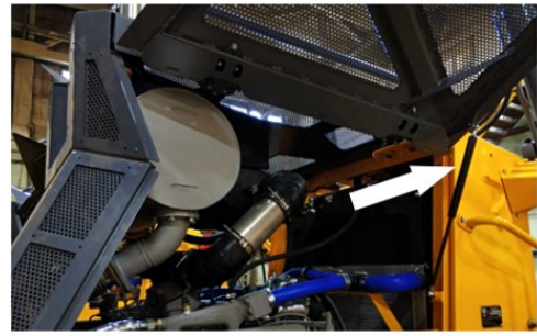
Рисунок 3.20. Газовый упор створки капота показан стрелкой
