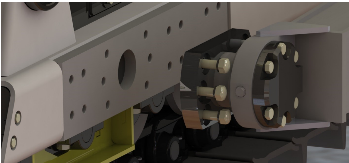
Рисунок 3.87. Монтаж брусьев на раму
