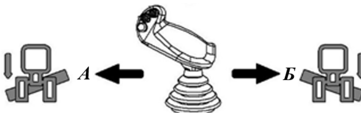
Рисунок 3.69. Приведение в действие гидроцилиндра перекоса отвала
