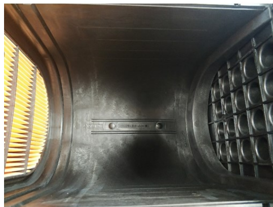
Рисунок 5.34. Внутренняя полость корпуса под установку основного фильтра
