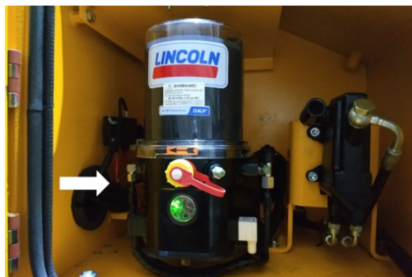
Рисунок 5.111. Система централизованной смазки для элементов ходовой и рабочего навесного оборудование
