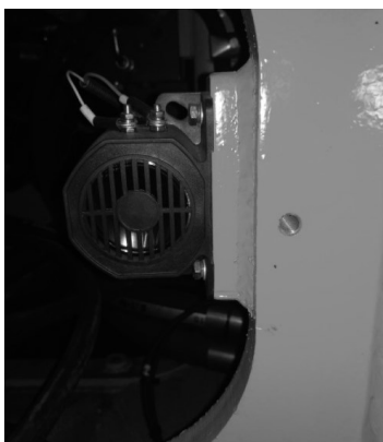
Рисунок 3.50. Гудок предупредительной сигнализации о движении задним ходом (задний щиток снят)
