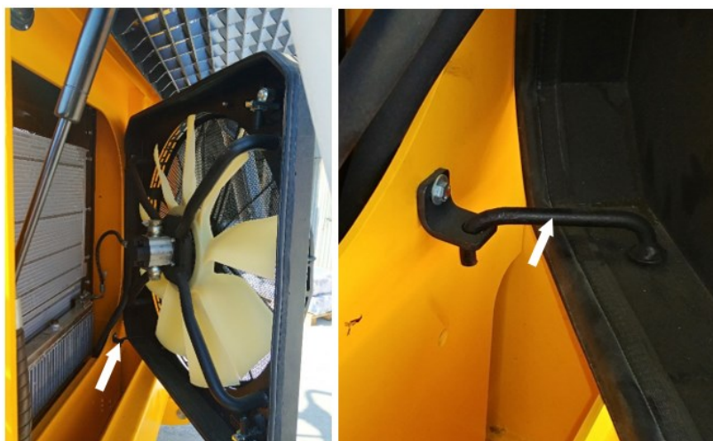
Рисунок 5.49. Фиксация рамы вентилятора в открытом положении (стрелками показано место расположения упора)
